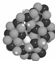
Modelo exibindo a estrutura tridimensional da sílica amorfa. As cavidades na estrutura, o pequeno tamanho e a elevada mobilidade do próton garantem que os prótons possam migrar profundamente na superfície da sílica.
